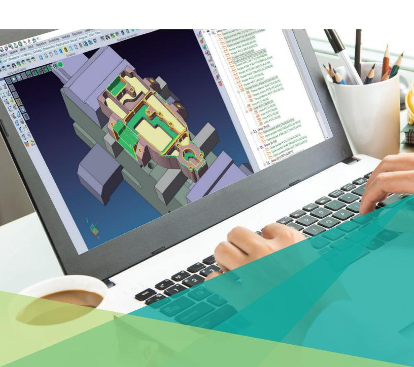
VISI Machining 2D provee una solución práctica, intuitiva y simple para la programación de CNC incluyendo la indexación de 4 y 5 ejes. Basándose en la opción "feature recognition", que reconoce en forma automática todas las característica a maquinar dentro del sólido para crear trayectorias confiables de la herramienta para operaciones de fresado y barrenado.
