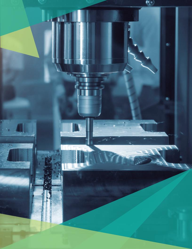
La optimización en los movimientos para las trayectorias de la herramienta asegura la distancia más corta para el desplazamiento de la herramienta y reduce los tiempos de ciclo, ofreciendo máxima productividad.
