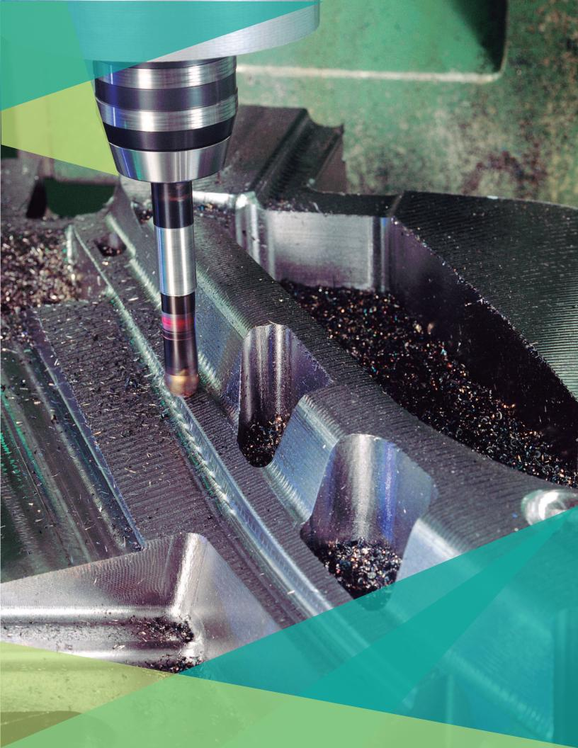
Las trayectorias en VISI se generan para maquinados de alta velocidad y cortes en metales duros. Se usan esquinas redondeadas, paros suaves y alimentación en arco para minimizar los cambios repentinos de dirección. La eliminación de retracciones de la herramienta, mantienen una carga constante de la hta. y optimizan los códigos NC, facilitando la programación de maguinas de alta velocidad con VISI.
