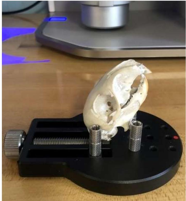
Después de montar el cráneo en la plataforma de escaneo, un clic dio vida a las avanzadas cámaras bicolor de Micro y las luces LED azules. Con una velocidad de adquisición de datos de 1 millón de puntos / segundo, las cámaras no permanecen en una posición por mucho tiempo. El cráneo se escaneó en dos posiciones para asegurar una cobertura total de todas las superficies, y cada escaneo tomó 4 minutos y 15 segundos.
