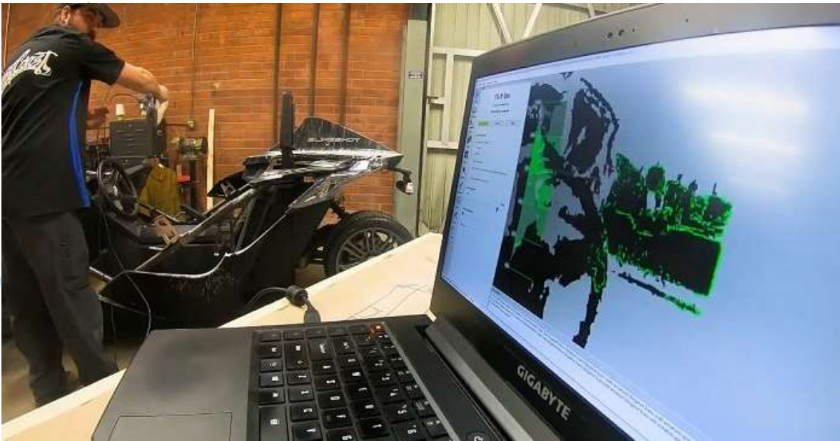
Escaneo 3D del futuro vehículo Star Trek Polaris Slingshot con el software Eva y Artec Studio
