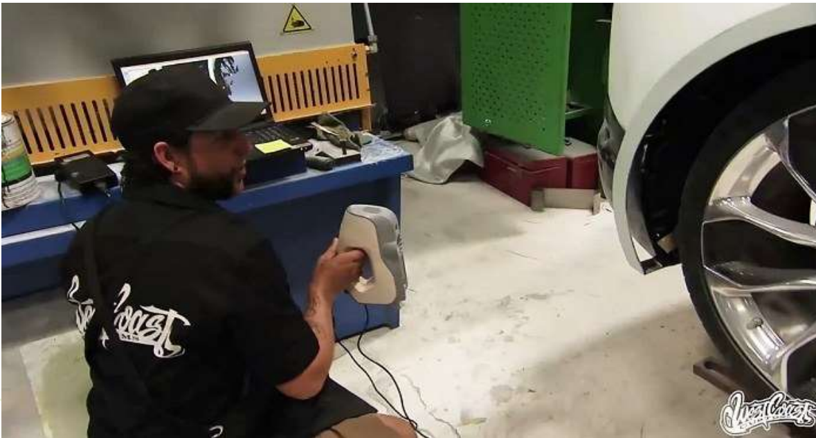
Escaneo 3D del futuro Black Panther Lexus con el software Eva y Artec Studio
